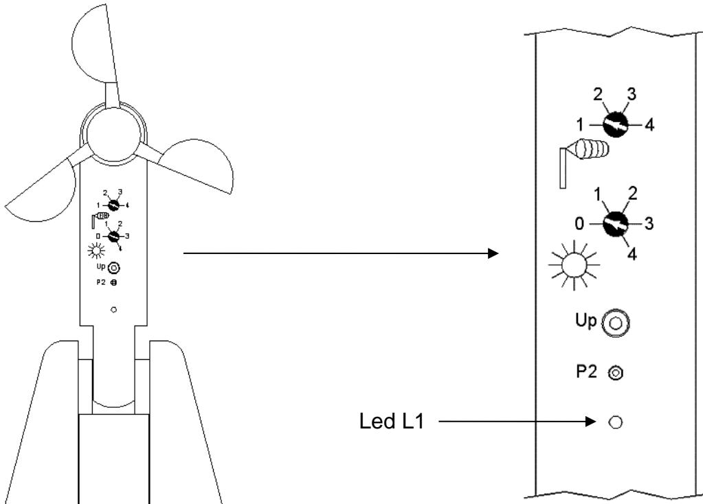
Il rif. 5119 aziona i sistemi di tende a rullo esclusivamente quando la velocità del vento o l'intensità della luce solare superano i valori di soglia impostati. Per i comandi standard (es. SU o GIÙ) dei motori tubolari sono sempre richiesti i telecomandi palmari o da parete Mottura a 433 MHz.
