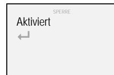
4. Über die Tasten „▲“ und „▼“ „Aktiviert“ auswählen und die Auswahl mit der Taste „■“ bestätigen (zur Bestätigung, dass die Betätigungsbefehlsperre aktiviert ist, wird das Abhaksymbol „✓“ angezeigt).
