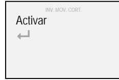
6. Mediante los botones "▲" y "▼" seleccionar "Activar" y confirmar con el botón "■" (aparece un símbolo de visto bueno "✓" confirmando la inversión del movimiento del sistema)
