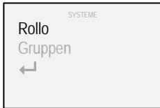
3. Über die Tasten „▲“ und „▼“ „Rollo“ auswählen und die Auswahl mit der Taste „■“ bestätigen.
