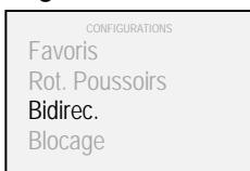
3. A l'aide des poussoirs "▲" et "▼" sélectionner "Bidirec." et valider à l'aide de la touche "■"
