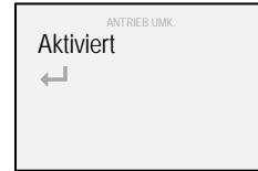
6. Über die Tasten „▲“ und „▼“ „Aktiviert“ auswählen und die Auswahl mit der Taste „■“ bestätigen (zur Bestätigung der Bewegungsumkehr des Systems wird das Abhakssymbol „✓“ angezeigt)
