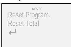
4. Mediante los botones “▲” y “▼” seleccionar “Reset Program.” y confirmar con el botón “■” (todos los datos relativos a los sistemas y a los grupos se mantendrán inalterados)
