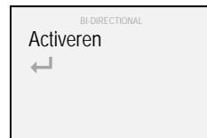
4. Kies met de knoppen “▲” en “▼” “Activeren” en bevestig met de drukknop “■” (een vinkteken “✓” verschijnt ter bevestiging van de activering van de bi-directionele R.F.-transmissie)
