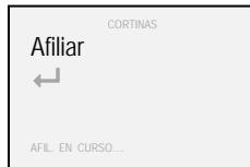
5. Presionar el botón R. F. del sistema que se desea afiliar hasta que se encienda el respectivo led (véase anexos “B” - “C” - “D” - “E” y eventualmente consultar el respectivo manual técnico). El sistema transmite el propio código identificativo al transmisor
