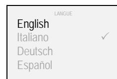
4. À travers les poussoirs “▲” et “▼” sélectionner la langue désirée et valider à l'aide de la touche “■”
