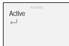
4. A l'aide des poussoirs "▲" et "▼" sélectionner "Active" et valider à l'aide de la touche "■" (une coche "✓" s'affiche pour confirmer l'activation du bloc de commande d'actionnement)
