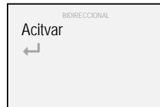
4. Mediante los botones “▲” y “▼” seleccionar “Activar” y confirmar con el botón “■”(aparece un símbolo de visto bueno “✓” confirmando la activación de la transmisión bidireccional R.F.)
