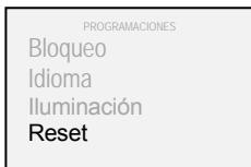
3. Mediante los botones “▲” y “▼” seleccionar “Reset” y confirmar con el botón “■”
