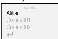
4. Mediante los botones “▲” y “▼” seleccionar el sistema a eliminar y confirmar con el botón “■”
