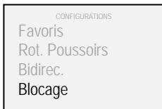
3. A l'aide des poussoirs "▲" et "▼" sélectionner "Blocage" et valider à l'aide de la touche "■"
