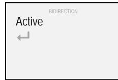
4. A l'aide des poussoirs "▲" et "▼" sélectionner "Active" et valider à l'aide de la touche "■"(une coche "✓" s'affiche pour confirmer l'activation de la transmission bidirectionnelle R.F.)
