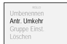
5. Über die Tasten „▲“ und „▼“ „Antr. Umkehr“ auswählen und die Auswahl mit der Taste „■“ bestätigen.
