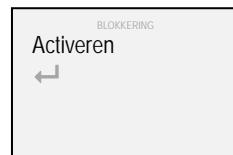
4. Kies met de knoppen “▲” en “▼” “Blokkering” en bevestig met de drukknop “■”(een vinkteken “✓” verschijnt ter bevestiging van de activering van de blokkering van de bedieningscommando's)
