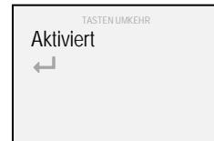
4. Über die Tasten „▲“ und „▼“ „Aktiviert“ auswählen und die Auswahl mit der Taste „■“ bestätigen (zur Bestätigung der aktiven bidirektionalen Funkansteuerung wird das Abhaksymbol „✓“ angezeigt).
