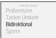
3. Über die Tasten „▲“ und „▼“ „Bidirektional“ auswählen und die Auswahl mit der Taste „■“ bestätigen.
