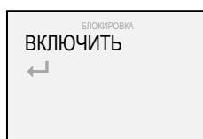
4. С помощью кнопок “▲” и “▼” выберите “ВКЛЮЧИТЬ” и подтвердите кнопкой “■” (в подтверждение подключения блокировки подачи команд на привод появляется галочка “✓”)
