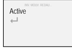
6. A l'aide des poussoirs "▲" et "▼" sélectionner "Active" et valider à l'aide de la touche "■" (une coche "✓" s'affiche pour confirmer l'inversion du déplacement du système).
