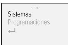
2. Mediante los botones “▲” y “▼” seleccionar “Sistemas” y confirmar con el botón “■”
