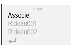
4. A l'aide des poussoirs "▲" et "▼" sélectionner le système à supprimer et valider avec la touche "■"
