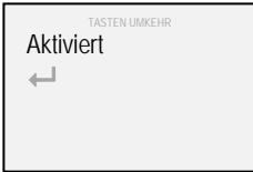
4. Über die Tasten „▲“ und „▼“ „Aktiviert“ auswählen und die Auswahl mit der Taste „■“ bestätigen (zur Bestätigung der Tastenumkehr wird das Abhaksymbol „✓“ angezeigt).
