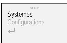
2. A l'aide des poussoirs "▲" et "▼" sélectionner "Systèmes" et valider à l'aide de la touche "■"
