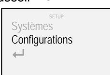
2. A l'aide des poussoirs “▲” et “▼” sélectionner "Configurations" et valider à l'aide de la touche “■”
