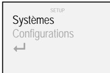
2. A l'aide des poussoirs “▲” et “▼” sélectionner "Systèmes" et valider à l'aide de la touche “■”
