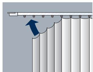
**1)** Aggiicare la tenda. **2)** Azionare il motore ed attendere che il sistema compia automaticamente un ciclo completo di chiusura-apertura della tenda. Il sistema è ora pronto per un corretto funzionamento. **3)** Per ripetere il ciclo di regolazione dei finecorsa, premere il «micro reset» a bordo motore.
