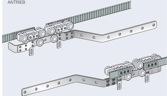
La trasmissione di potenza è realizzata con un anello di cinghia dentata in poliuretano con trefoli in acciaio (carico max a trazione 2,920 N)
