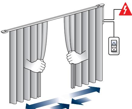
AUTOSTART® è il dispositivo elettronico che mette automaticamente in funzione il sistema in caso di azionamento da parte di utenti privi di familiarità con i sistemi motorizzati e permette anche l'apertura manuale delle tende nei casi di emergenza come la mancanza di corrente.
