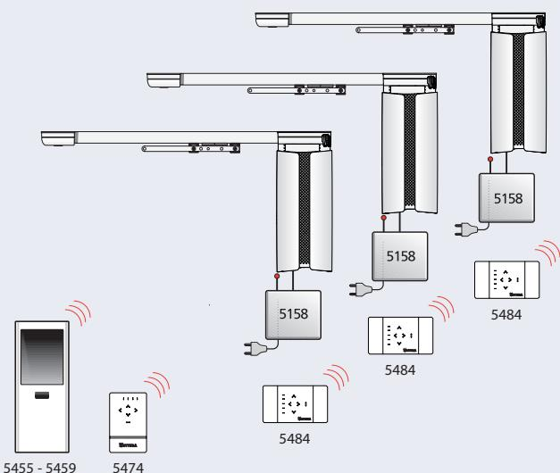
**3-** comando singolo e simultaneo con telecomando
